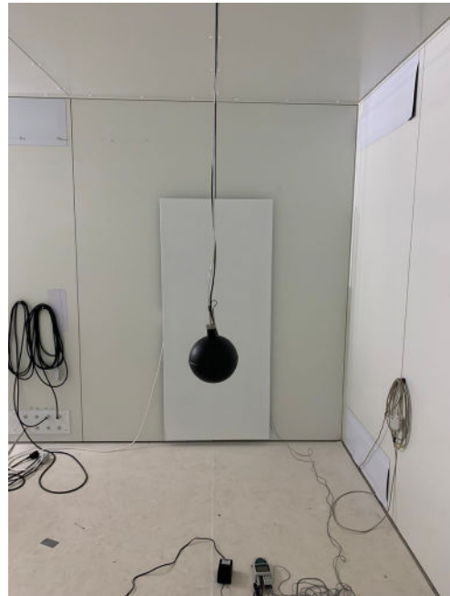
Abbildung 4: Versuchsaufbau Infrarotheizung (Seitenwand) IRH_SW ( P_{el} = 1500 \text{ W} )
