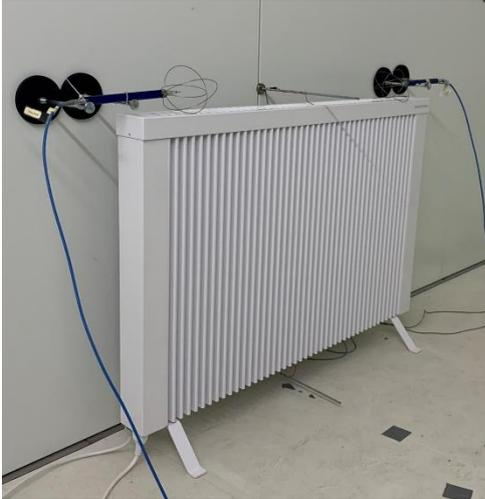
Abbildung 3: Detailansicht Teilspeicherheizung mit installierter Messtechnik
