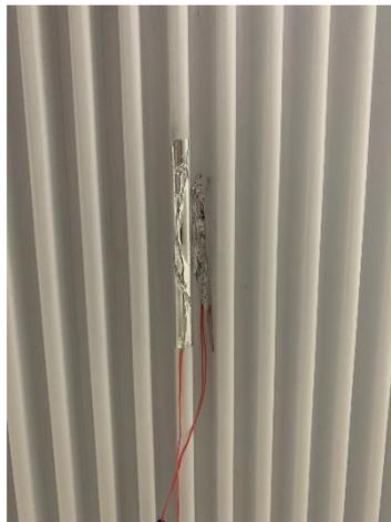
Abbildung 6: Temperatursensoren auf der Rückseite der Teilspeicherheizung (exemplarisch)
